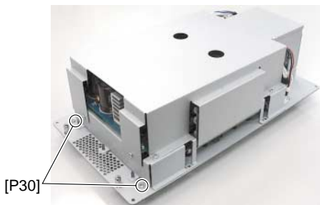
[P30]: Bind Head Screw ( 小ネジ + BIND ) M3.0X8 CR3 (AAX61910) Photo 14 ( 写真 14)
