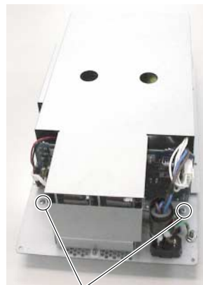
[P30]: Bind Head Screw ( 小ネジ + BIND ) M3.0X8 CR3 (AAX61910) Photo 15 ( 写真 15)
